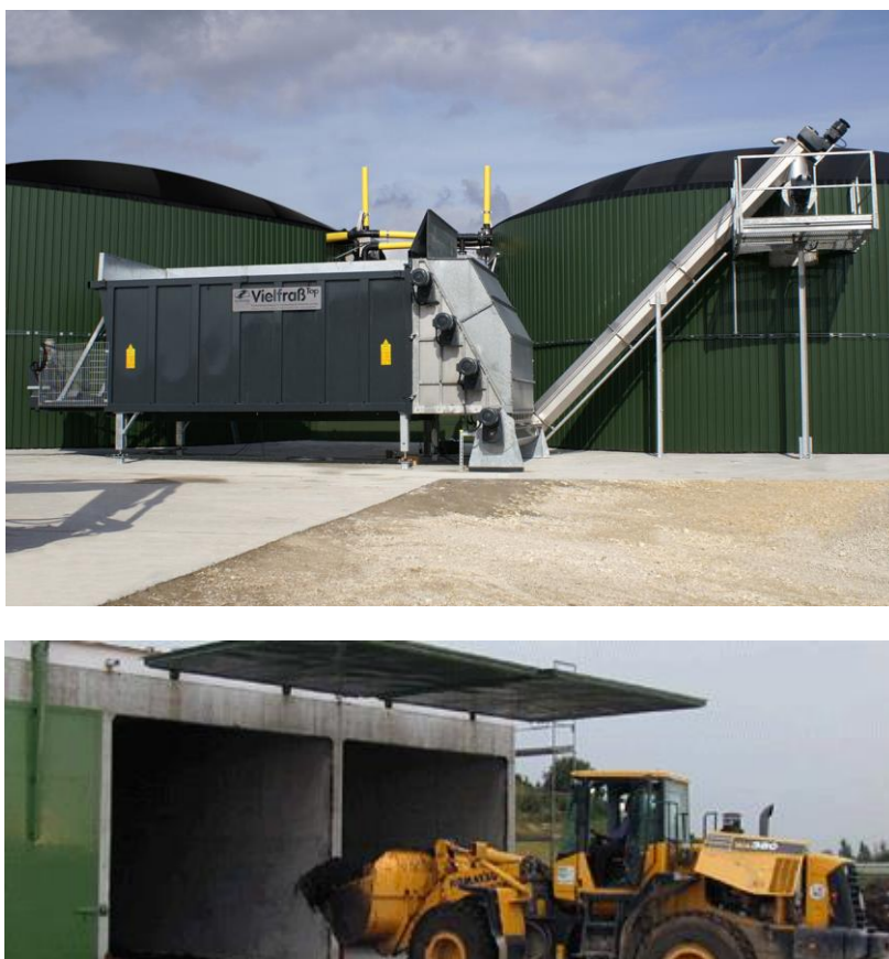
Фигура 9: Система за зареждане на входящите материали: чрез тръбопровод (източник: „Veltrass“) и чрез челен товарач
